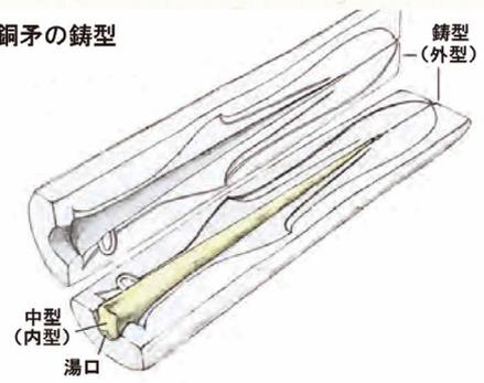
のが朝鮮半島からもたらされ、有力者の墓に納められました。やがて日本でも製作されるようになり、中細形→中広形→広形と大型化し祭器になります。青銅器は、溶かした青銅を鋳型に流し込んで造る鋳造品です。鋳造の時は、右図のように土製の中型を入れ、袋部に溶銅が回らないようにします。中型は鋳造後に取り出しますが、銅矛が中広形・広形と大型化して、武器形の祭器になると、柄を取り付けられないため、中型は製品から取り出されなくなります。
