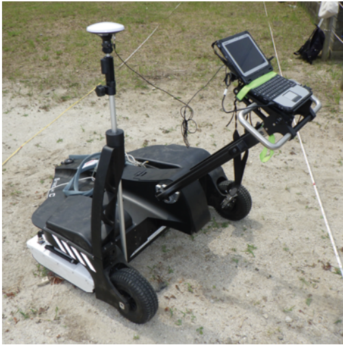
▲地中レーダー探査機 三輪を持つ扁平な機体には、正確な位置情報を得るためのGPSとハンドルにはパソコンを設置する。
