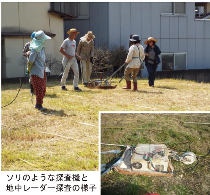
ソリのような探査機と地中レーダー探査の様子
