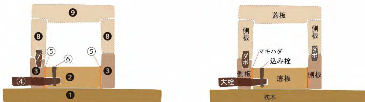
図3-8 大土居水城跡で確認された木樋の構造復元図
