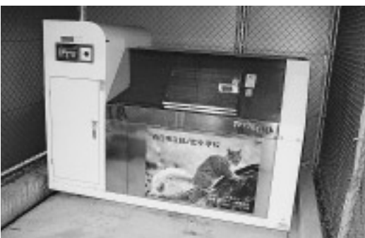
日の出小に設置されている生ごみ処理機
