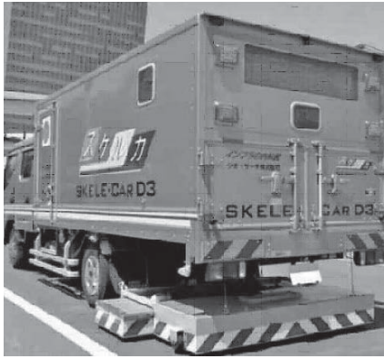
探査車「スケルカ」は時速60キロで走行しながら空洞探査が可能
