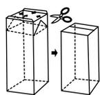
1000mlの牛乳パックの口を開き、四隅を切り込みます。切り込んだ4面を折り畳んで、接着剤ではって箱にします。
