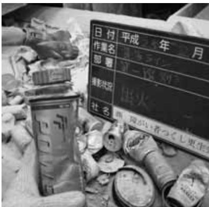
▲発火したガストーチ
