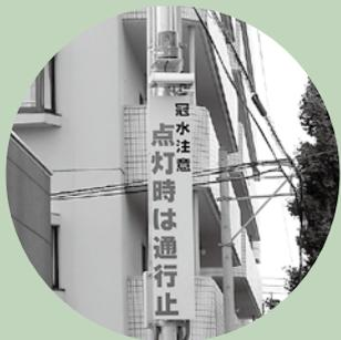
△冠水状況をセンサーで感知し、回転灯で注意喚起します。
