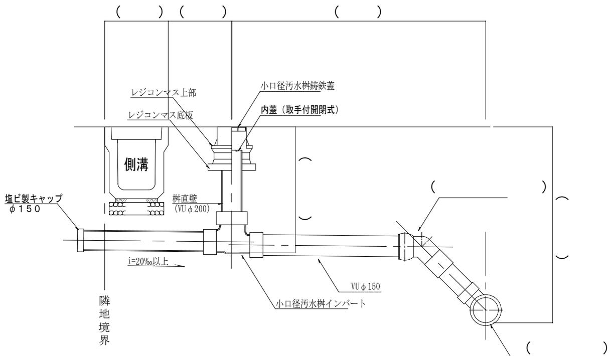
※ 本管土被り1.4m以上の場合、管頂接合・90°エルブ継手を使用すること
